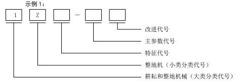
示例 2: 工作幅宽 4.5 m 第二次改进的悬挂对置式联合整地机表示为 1ZLD-4.5B。
